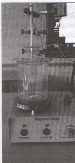
Рисунок 4 — Вид используемого в эксперименте калориметра
