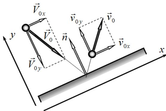
Вектор скорости движущегося тела  $\vec{V}_0$  удобно разложить на две составляющие: параллельную плоскости -  $\vec{V}_{0x}$  (тангенциальная составляющая); перпендикулярную плоскости -  $\vec{V}_{0y}$  (нормальная составляющая). Обозначим вектор скорости после удара  $\vec{v}_0$ . Будем считать, что проекции этого вектора связаны с компонентами вектора скорости до удара следующими соотношениями:
