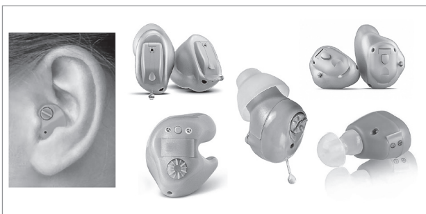
Рис. 6. Индивидуальные слуховые аппараты внутриушного типа
