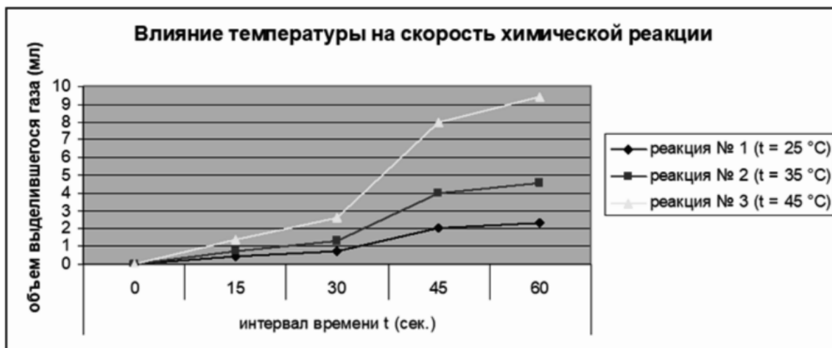
Рисунок 3. — Зависимость скорости химической реакции (NaHCO 3 + HCl = NaCl + H 2 O + CO 2 ↑) от температуры
